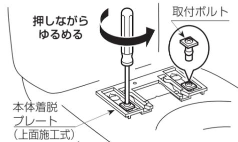
※取付ボルトが外れにくい場合、ゆるめた後、ボルトを押し込んでください。
